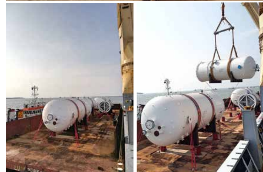
Shift Converter L11.89 m x W4.79 m x H4.92 m 43 ton
